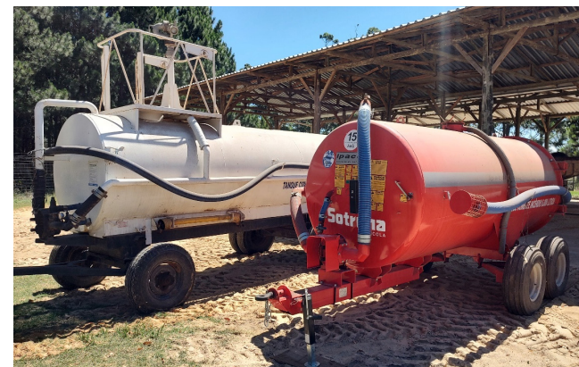
Tanque móvel utilizado para combate à incêndios.
