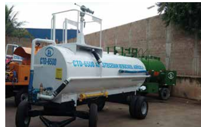
Tanque móvel utilizado para combate à incêndios.
