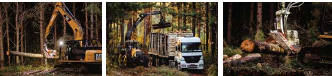
Sequência de fotos com diferentes etapas da colheita: corte, seccionamento e baldeio, em operação de Desbaste.
